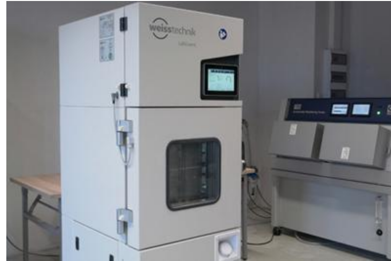
Komora klimatyczna WeissTechnik (LabEvent L C/34/40/5)
